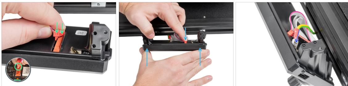
● Schließen Sie das xLCD-Kabel an den xLCD-Steckplatz auf der Platine an.
