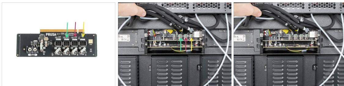
**!** Nehmen Sie die XL-Splitterplatte nicht aus dem Drucker heraus, das Foto ist nur eine Illustration der Anschlusspositionen.
