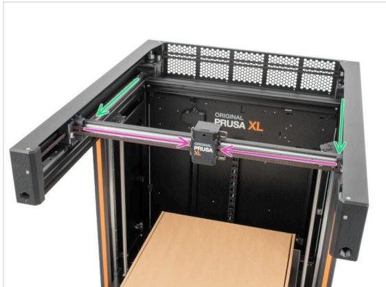
**⚠** Zur Erinnerung: Um den Drucker zu bewegen, **fassen Sie den Drucker immer an den Griffen auf beiden Seiten an**. Heben Sie den Drucker nicht an den Aluminiumprofilen oder den oberen Blechprofilen an.
