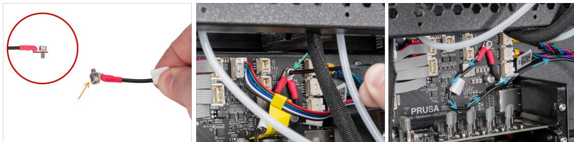
**⚠️** Nota il corretto orientamento del connettore del cavo PE.
