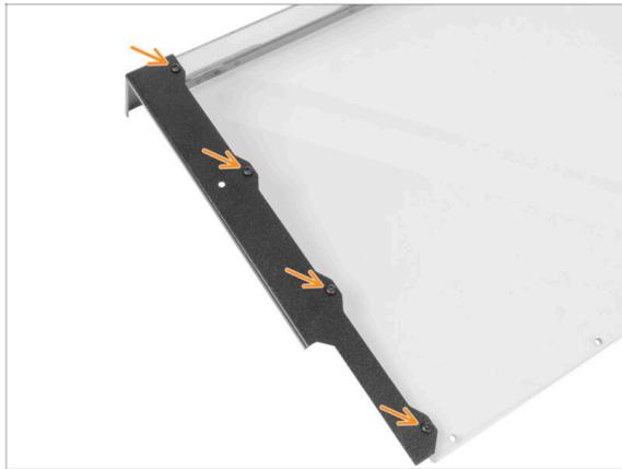
✚ Inserisci quattro viti M4x8r nei fori e fissale con i dadi M4n usando una chiave a brugola da 2,5 mm.
