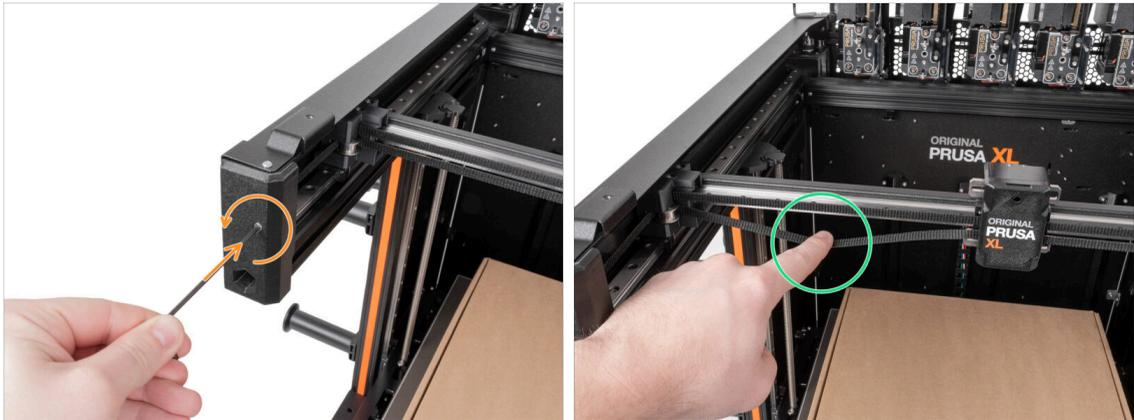
⚠ Les belt-clamps doivent être remplacés car les pièces d'origine **ne conviennent pas aux températures plus élevées** qu'ils connaîtront à l'intérieur de l'Enclosure. **Les nouvelles pièces sont résistantes aux hautes températures.**
