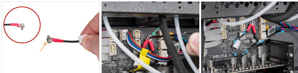
**⚠ Observa la orientación correcta del conector del cable PE.**
