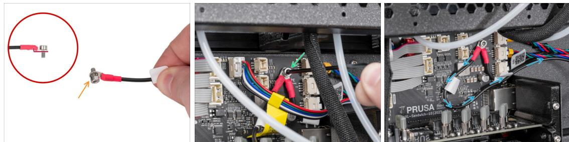
**⚠ Achten Sie auf die richtige Ausrichtung des PE-Kabelanschlusses.**
