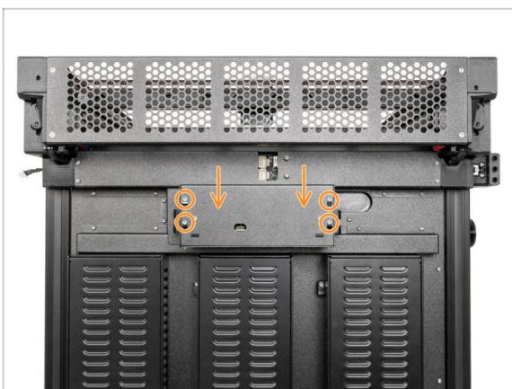
ⓘ In questa fase, copri temporaneamente l'elettronica. Questo serve a proteggere l'elettronica durante l'installazione delle teste degli strumenti nel capitolo successivo. Non è necessario stringere il coperchio dell'elettronica.
