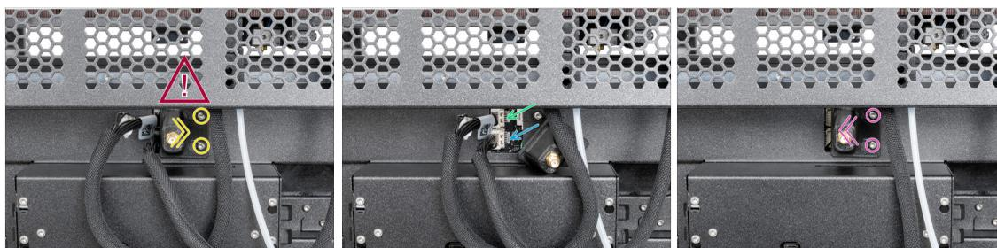
**⚠ Il y a un câble d'antenne derrière le support d'antenne, ne tirez pas sur le connecteur !**
