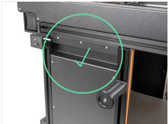
**⚠ Nunca manipules la impresora utilizando los lados metálicos superiores. Puedes dañar las luces LED ocultas en el interior.**
