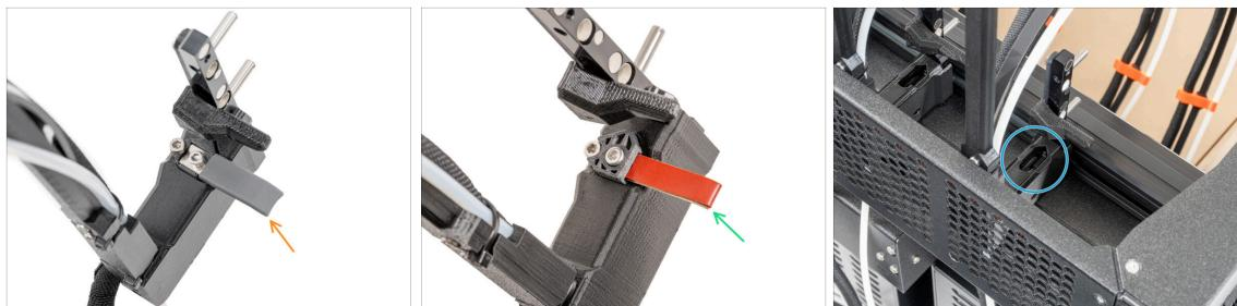
ⓘ Bei den neuesten Baugruppen ist die Düsendichtung bereits auf dem Extruderdock installiert.
