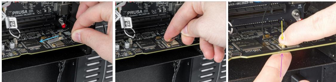
**i** Vous disposez peut-être d'une autre version du support d'antenne Wi-Fi (**le câble de l'antenne ne peut pas être trouvé pour le moment**). Une nouvelle version du support d'antenne se trouve dans **5. Assemblage de l'extrudeur & des accessoires**. **N'installez pas encore l'antenne !** Continuez simplement à suivre le manuel.
