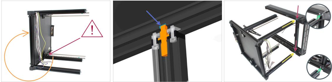
**⚠ Vérifiez que les assemblages fixes et rotatifs de l'axe Z sont dans aux bonnes positions. Sur la photo, l'axe Z fixe est en bas, ce qui est correct. Vérifiez votre imprimante !**
