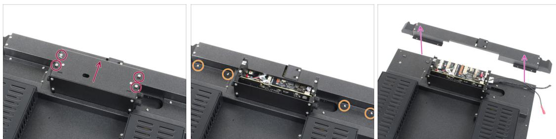
ⓘ Afin de pouvoir brancher les câbles, nous devons ouvrir le boîtier contenant l'électronique. **Ne jetez pas les caches ni la visserie !**
