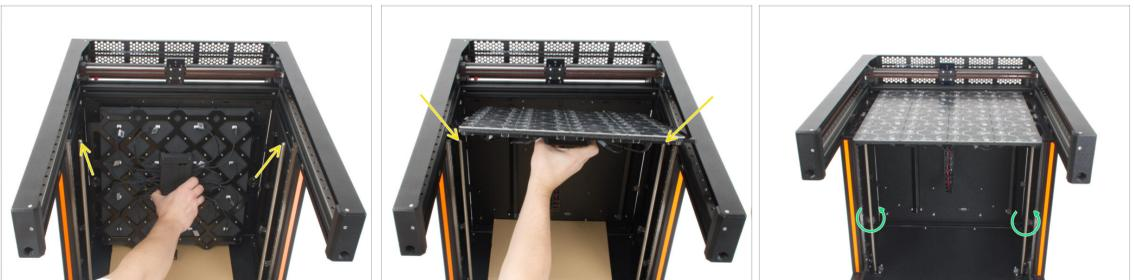
➤ Prenez le Plateau chauffant et fixez-le au sommet des tiges filetées. Les deux écrous trapézoïdaux latéraux doivent s'engager sur une tige filetée.
