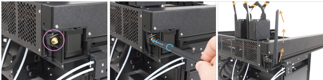
◆ Localisez le connecteur de l'antenne Wi-Fi dans le coin arrière gauche de l'imprimante.
