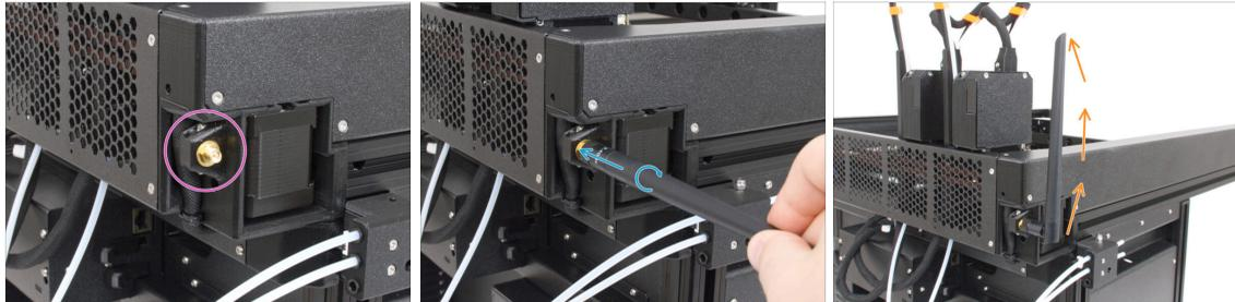
● Localiza el conector de la antena Wi-Fi en la esquina posterior izquierda de la impresora.
