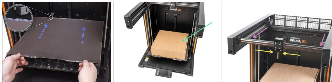
**⚠ Zur Erinnerung: Um den Drucker zu bewegen, fassen Sie den Drucker immer an den Griffen auf beiden Seiten an. Heben Sie den Drucker nicht an den Aluminiumprofilen oder den oberen Blechprofilen an.**
