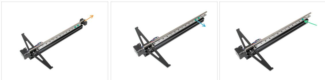
**!** **Schieben Sie das Lager niemals aus der Führungsschiene, Sie könnten die Lagerkugeln verlieren!**
