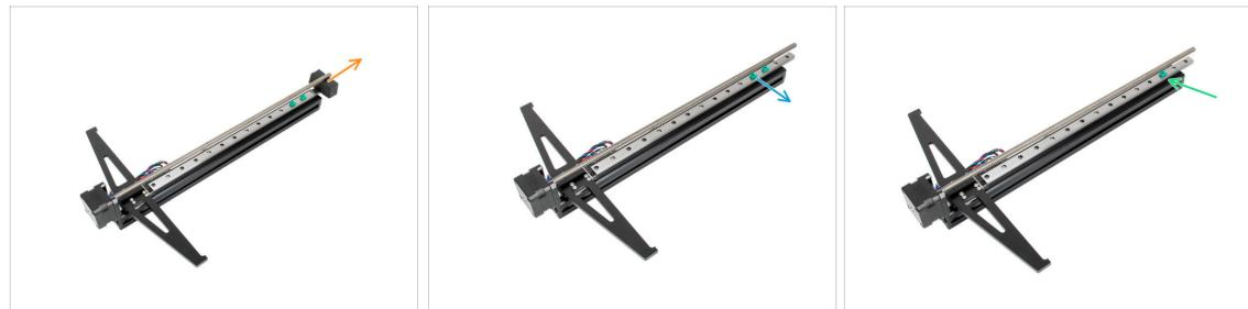
**⚠ Nikdy ložisko nevysouvejte z lišty, hrozí ztráta ložiskových kuliček!**
