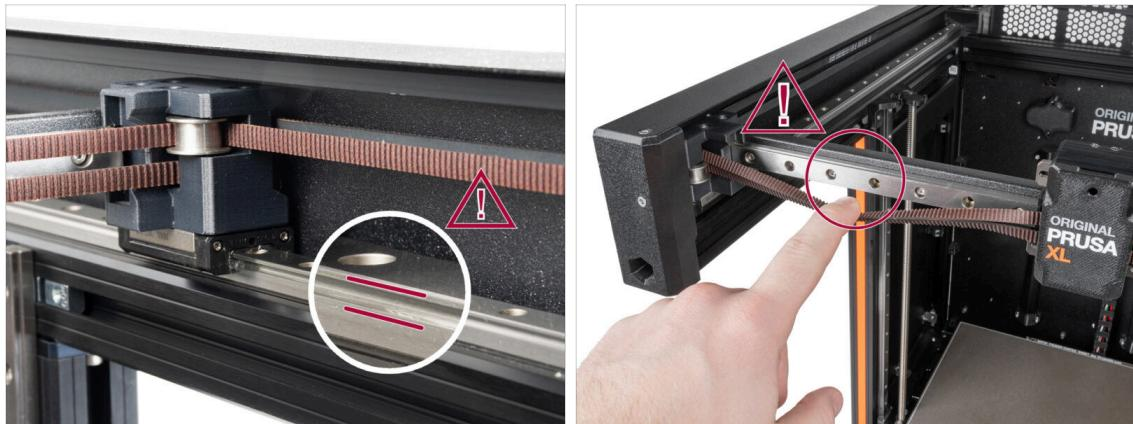
**⚠️ UPOZORNĚNÍ:** Vyvarujte se přímého kontaktu pokožky s mazivem používaným pro lineární vedení v této tiskárně. Pokud dojde ke kontaktu, okamžitě si umyjte ruce. Zejména před jídlem, pitím nebo dotýkáním se obličeje.
