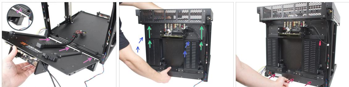
**⚠️ Zadní panel XL držte při montáži rukou! Není zajištěn žádnými šrouby.**
