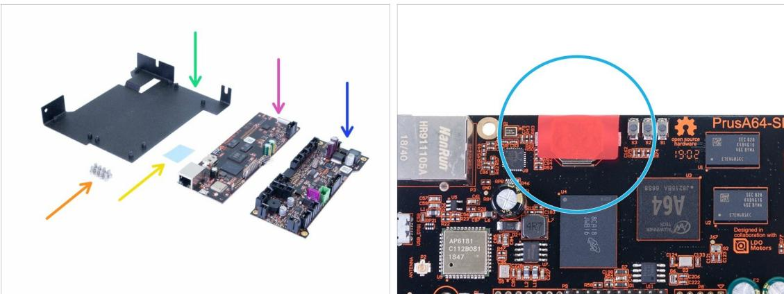
⚠ **Maneggia l'elettronica con estrema attenzione.** Evita di toccare i chip e i condensatori sulle schede, prendile sempre dai bordi. **Lasciale nelle buste antistatiche per il momento.**
