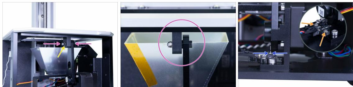
**⚠ ATTENZIONE:** prenditi tutto il tempo necessario per questo passaggio ed accertati che il sensore sia calibrato correttamente. Questo ti permetterà di evitare possibili problemi durante le stampe.
