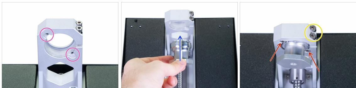
**⚠ ATTENZIONE:** Questo passo implica l'inserimento di componenti dalla parte inferiore e potrebbe essere un po' difficile. Puoi coricare la stampante sulla parte posteriore, ma usa il cartone per proteggere il bottone d'alimentazione dell'alimentatore.
