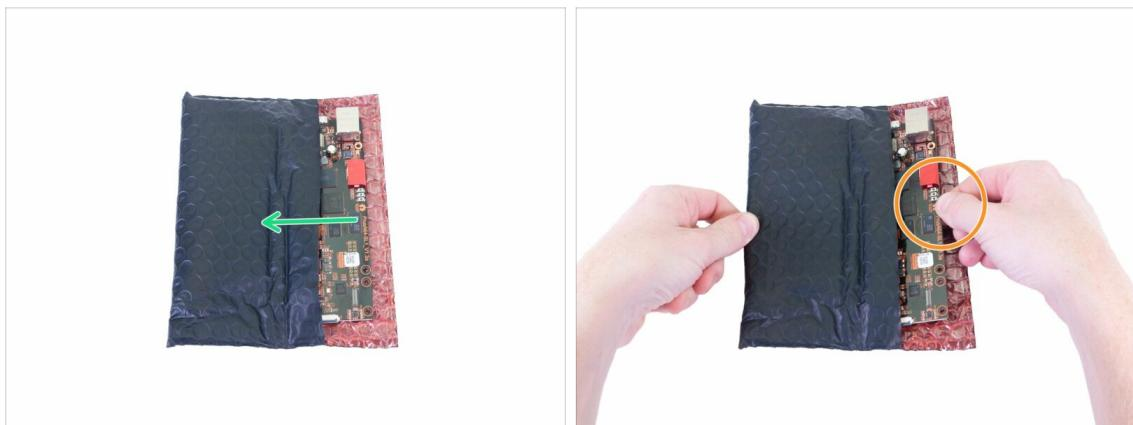
**⚠ ATTENZIONE:** Accertati di proteggere l'elettronica dalle scariche elettrostatiche (ESD). Spacchetta sempre l'elettronica solo non appena ti serve!
