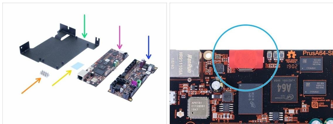
**⚠ Manipulez les composants électroniques avec une extrême prudence. Évitez de toucher les puces et les condensateurs des deux cartes, tenez-les toujours par les bords. Laissez-le dans les sacs antistatiques pour l'instant.**
