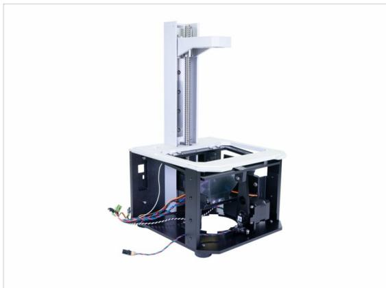
**⚠** À partir de maintenant, veuillez toujours utiliser la partie inférieure de l'imprimante lorsque vous vous déplacez avec l'imprimante. **Évitez d'utiliser la colonne ou le cantilever** !
