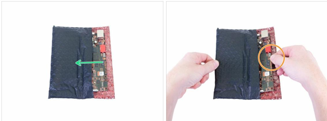
**⚠ ADVERTENCIA:** Asegúrate de proteger la electrónica contra descargas electrostáticas (ESD). ¡Desempaquetá siempre los componentes electrónicos justo antes de que los necesites!
