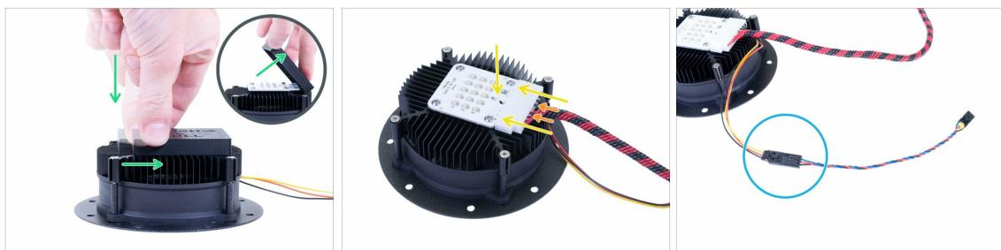
**⚠ ADVERTENCIA:** Despues de quitar la cubierta del LED UV, evita tocar los diodos. Cualquier suciedad o grasa en la superficie puede provocar artefactos en la impresión.
