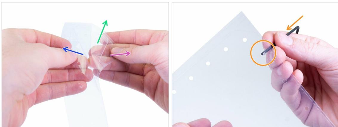
**⚠ ADVERTENCIA:** el siguiente procedimiento es crucial. ¡Asegúrate de leer las instrucciones primero! La lámina FEP consta de tres capas. Dos capas son para la protección de la capa intermedia, que es la película FEP.
