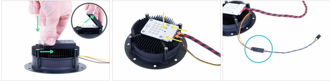
**⚠ ADVERTENCIA:** Después de quitar la cubierta del LED UV, evita tocar los diodos. Cualquier suciedad o grasa en la superficie puede provocar artefactos en la impresión.
