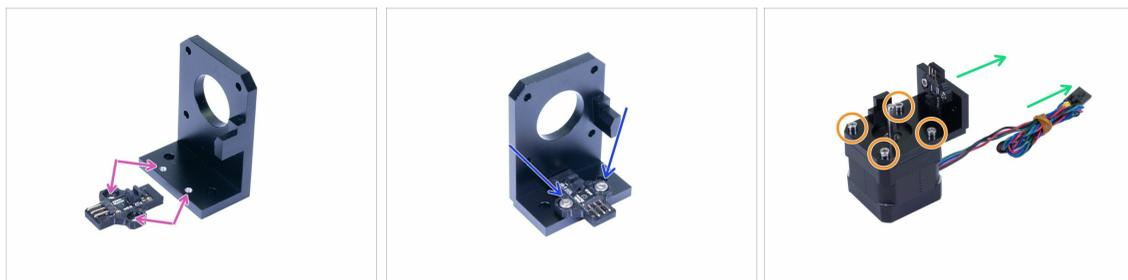
● Verifica el soporte del motor de inclinación para ver los puntos de montaje, que se utilizarán para el sensor óptico.
