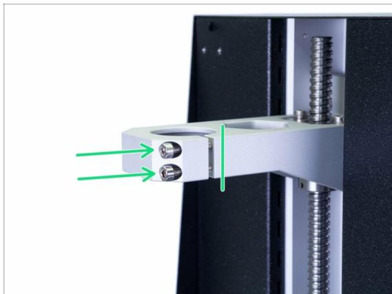
● Inserta dos tornillos M4x25. No los atornilles completamente. Es suficiente alcanzar los hilos detrás del hueco. Necesitamos asegurarnos de que los tornillos no se caigan.
