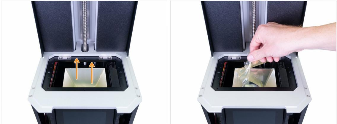
● Retira con cuidado la película protectora del reflector. Evita tocar la superficie interna del reflector.
