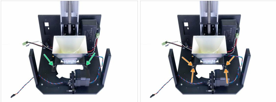
● Coloca el reflector dentro de la impresora y asegúralo ligeramente usando dos tornillos M4x5. El reflector es simétrico, la orientación no importa.
