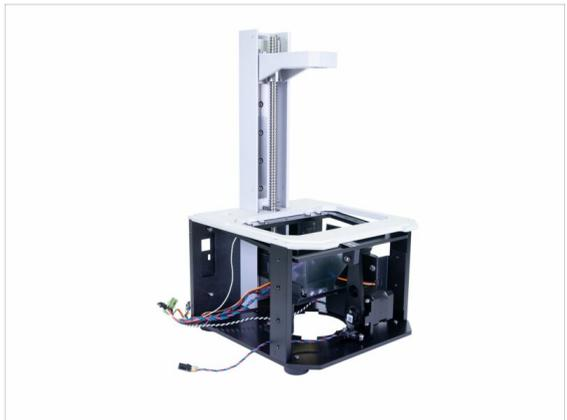
⚠ A partir de ahora, utiliza siempre la parte inferior de la impresora mientras mueves la impresora. **¡Evita usar la torre o el sistema cantilever!**
