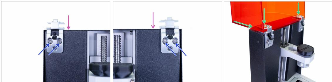
⚠ **Asegúrate de no dejar caer las bisagras durante el montaje. Puedes usar cualquier tela para proteger la película FEP y la pantalla de impresión debajo de las bisagras.**
