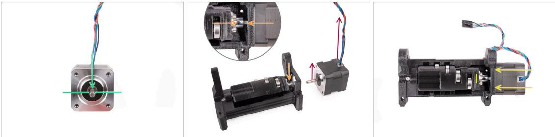
**i** Bevor wir den Motor in die Baugruppe einbauen, müssen wir die Motorwelle und die Idler-Kupplung ausrichten.
