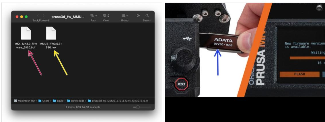
**⚠ DŮLEŽITÉ!!!** Než budete pokračovat dále; Existují dva soubory firmwaru. Jeden je určen pro tiskárnu. Druhý je pro jednotku MMU3. Oba je třeba flashnout do příslušného zařízení.
