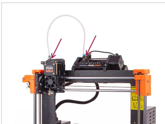
◆ Fixez le tube PTFE sur l'imprimante en l'insérant dans les raccords. Une extrémité va sur le sélecteur. L'autre va sur l'extrudeur.
