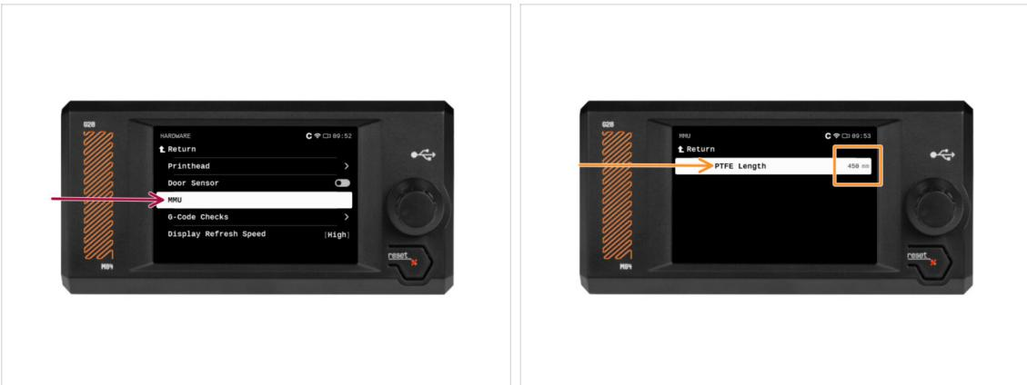
**⚠** È necessario impostare nel firmware la lunghezza del tubo PTFE MMU-to-Extruder.
