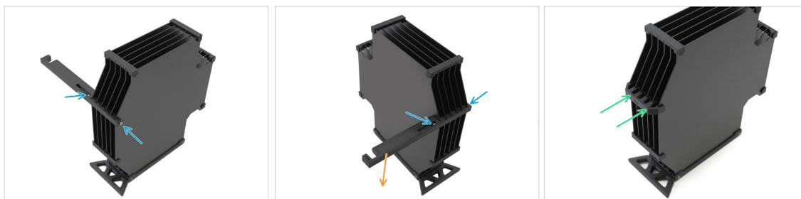
● Rimuovi le viti M3x30 che tengono il supporto della stampante.
