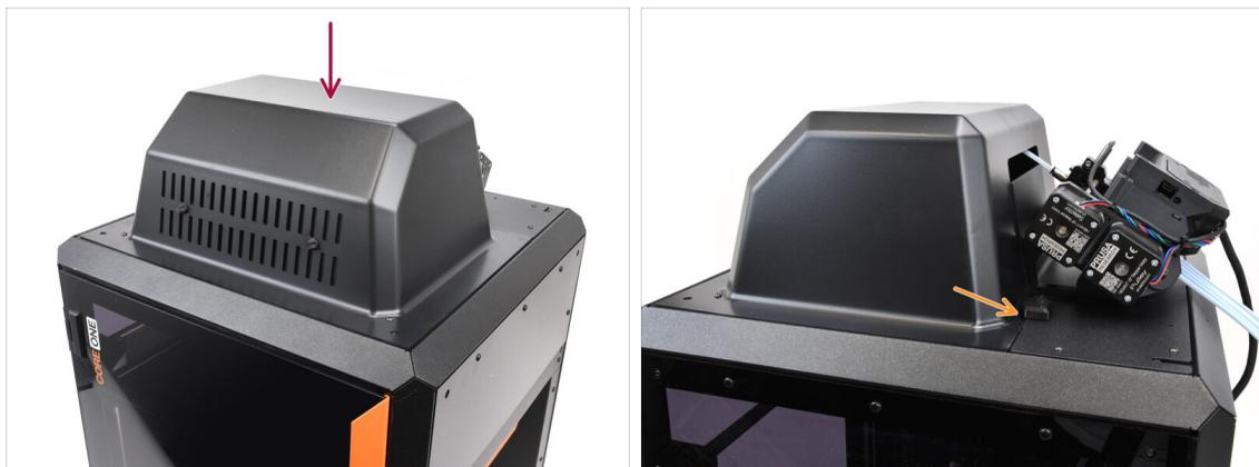
➤ Wenn Sie die Enclosed Version verwenden, decken Sie den Drucker mit der Oberen Abdeckung ab.
