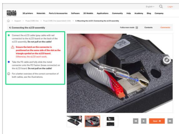
**⚠ Per completare correttamente il montaggio del kit MK4S, segui tutte queste indicazioni:**
