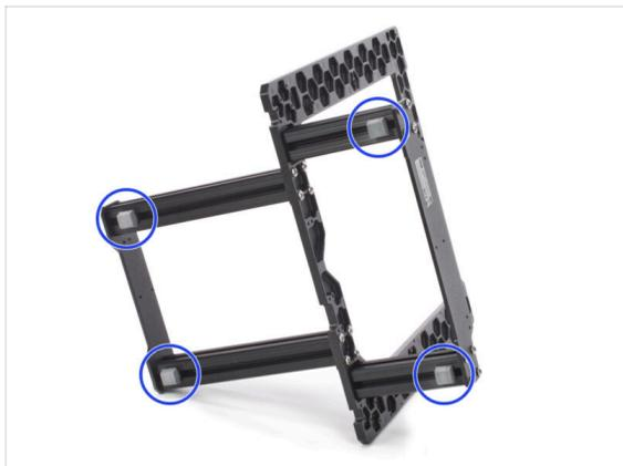
● Ruota l'intero telaio su un lato e inserisci un piedino antivibranti nella scanalatura inferiore di ogni profilo estruso. Inseriscilo e ruotalo di 90 gradi per bloccarlo in posizione.
