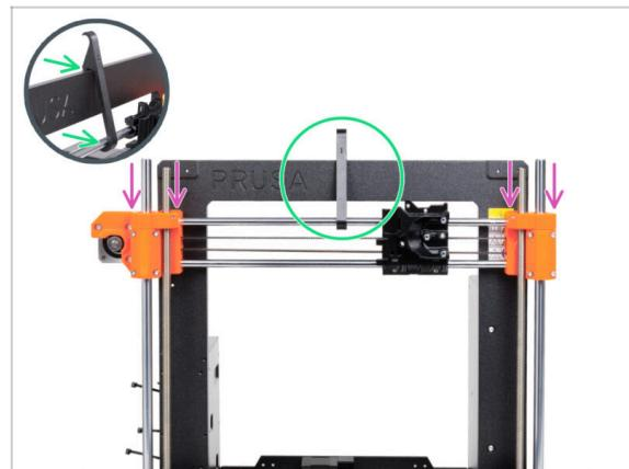
◆ Desliza con cuidado el conjunto del eje X sobre las varillas lisas del eje Z.
