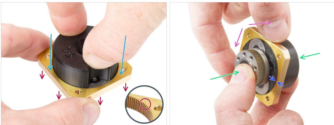
**⚠️ No monte la caja de cambios sin el PG-assembly-adapter.** Esta herramienta está destinada a garantizar que los engranajes encajen correctamente.
