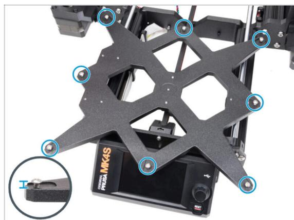
● Instala ocho tornillos M3x6r en los orificios exteriores del carro Y. **No los aprietes completamente.** Unas pocas vueltas son suficientes por ahora.
