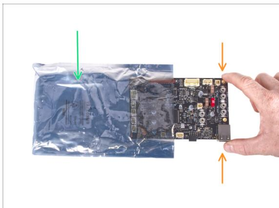
**⚠ ADVERTENCIA:** Asegúrate de **proteger la electrónica contra descargas electrostáticas (ESD)**. ¡Desempaqueta siempre los componentes electrónicos justo antes de que los necesites!
