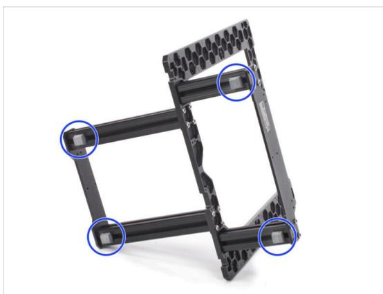
● Gira todo el conjunto del marco hacia un lado e inserta un pie antivibración en la ranura inferior de cada extrusión. Insértalo y gíralo 90 grados para bloquearlo en su sitio.
