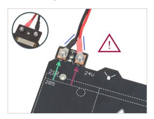
Repite este procedimiento para el segundo cable (Rojo / + / VCC). Utiliza el extremo del cable que no está etiquetado con el código QR. El código QR debe estar en el otro extremo.
