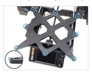
Instala ocho tornillos M3x6r en los orificios exteriores del carro Y. No los aprietes completamente. Unas pocas vueltas son suficientes por ahora.
