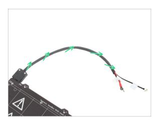
Termine de envolver el haz de cables en la funda textil. Y retuerze la funda, no los cables.
