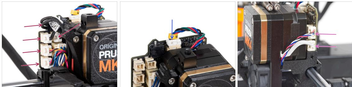
**⚠** **Ten en cuenta que hay pestillos de seguridad en cada uno de los conectores que deben ser empujados, con el fin de eliminar el conector.**
