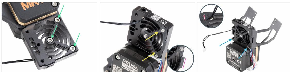
● Desde la parte frontal del Nextruder (lado de la pg-case con el logo de la impresora), inserta tres tornillos M3x12 en el disipador.
