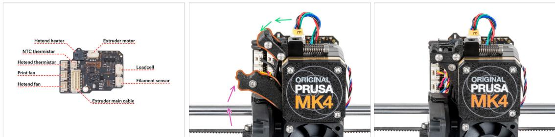
⚠ 電子機器をカバーする前に、すべてのケーブルの接続を確認します。左上の高解像度プレビューをクリックしてください。
