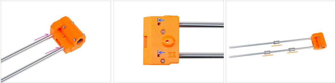
✿ Insérez les tiges lisses jusqu'au bout dans le X-end-idler.
