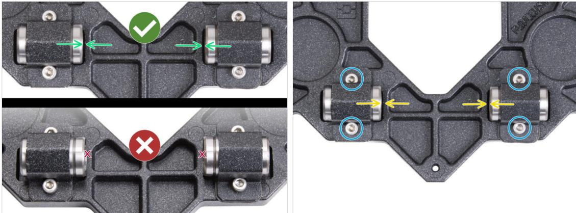
⚠ **Un bon alignement des roulements est CRUCIAL.** Procédez avec précaution et assurez-vous que **les deux roulements sont aussi proches du centre du Y-carriage que possible et ne touchent aucun bord de l'emplacement.**
