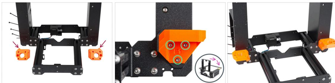
**⚠ ATTENTION :** Les pièces imprimées ne sont pas les mêmes ! Il y a des pièces gauche et droite. Voir la saillie (dent) sur chaque pièce. Pour le côté droit du cadre, il y a une saillie sur le côté droit de la pièce en plastique et vice versa.
