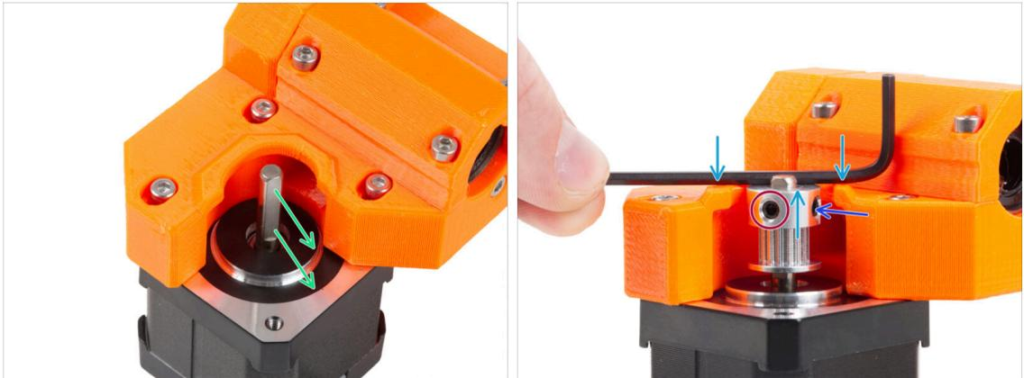
● Il y a une partie plate sur l'arbre du moteur. Faites tourner l'arbre du moteur avec la partie plate tournée vers l'ouverture du X-end-motor.
