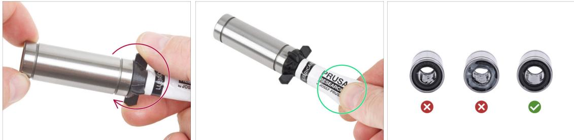
● **Tournez le tube et l'applicateur dans le sens inverse des aiguilles d'une montre** jusqu'à ce que vous sentiez une légère résistance. Cela signifie que les trous de l'applicateur sont alignés avec les rangées de billes.
