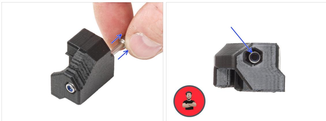
◆ Insérez l'écrou M3nN dans le Y-belt-holder en utilisant la technique de tirage avec vis. **Assurez-vous qu'il est positionné le plus loin possible dans la pièce.**
