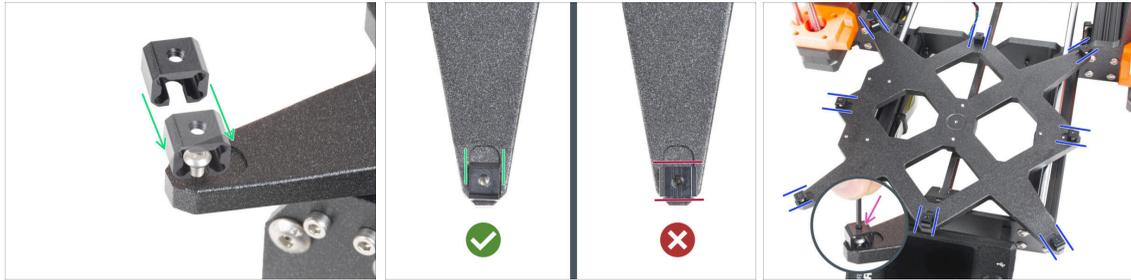
**⚠ La instalación de las juntas de dilatación debe realizarse con cuidado. Es crucial para el correcto funcionamiento de la impresora. Lee atentamente las instrucciones:**
