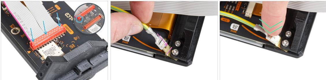
● Conecta el cable xLCD a la placa xLCD. Fíjate en el pestillo de seguridad del conector del cable xLCD. Debe enchufarse en el lado de la ranura xLCD marcado con el triángulo naranja en la placa.
