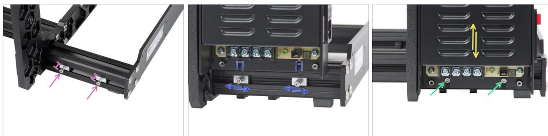
● Echa un vistazo al lado derecho del marco y localiza las tuercas M3nE. Inserta tornillos M3x10 en ellas. Gíralos sólo 3-4 veces utilizando una llave Allen de 2,5mm, sólo para que los tornillos se mantengan en su sitio.
