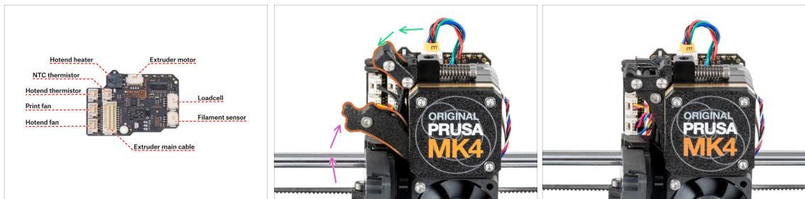
**⚠️ Bevor Sie die Elektronik abdecken, überprüfen Sie den Anschluss aller Kabel.**
