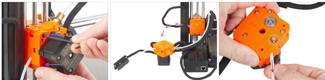
**💡** Les étapes suivantes montreront comment remplacer le tube PTFE d'entrée d'origine par un tube plus long. Le remplacement du tube PTFE d'entrée par un tube plus long est facultatif, mais recommandé pour une insertion plus facile du filament. Si vous ne souhaitez pas remplacer le PTFE, passez à [Câble USB : préparation des pièces](#).
