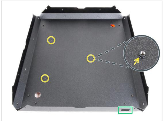
◆ Empuja el inserto del damper en el damper antideslizante. No importa el lado, el amortiguador antideslizante es simétrico.
