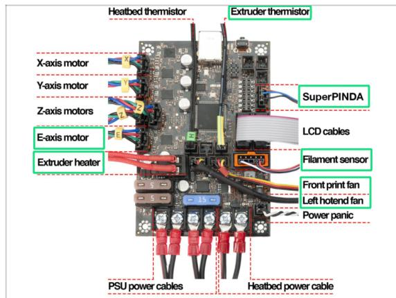
**⚠️** Le connessioni differiscono a seconda della stampante che hai. Per la MK3S/, utilizza questo passo. Per la MK2.5S, passa al successivo.
