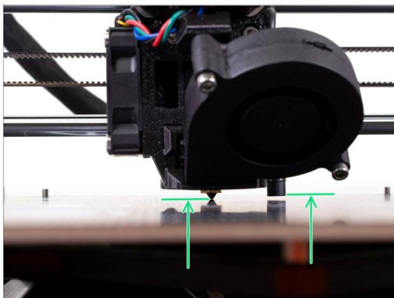
**⚠ IMPORTANTE:** la regolazione della SuperPINDA è necessaria solo nel caso in cui tu abbia smontato l'intero estrusore e spostato il sensore. In caso contrario (ad es. possessori di MK3S e MK3S+), puoi saltare al passo 5.
