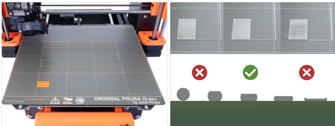
**⚠ IMPORTANTE:** Questo passo è necessario solo se hai regolato la posizione del sensore SuperPINDA nel capitolo precedente. Altrimenti, puoi saltare al passo successivo e usare la funzione Live Adjust Z come al solito per mettere a punto il primo strato.
