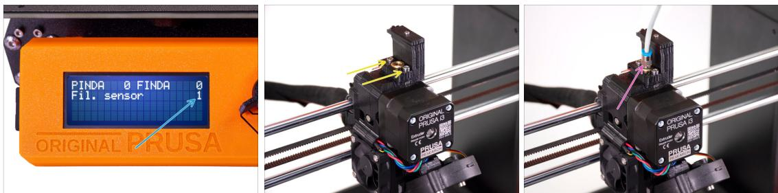
**⚠️ Calibrare il sensore IR di filamento è fondamentale affinché l'unità MMU2S funzioni correttamente.**
