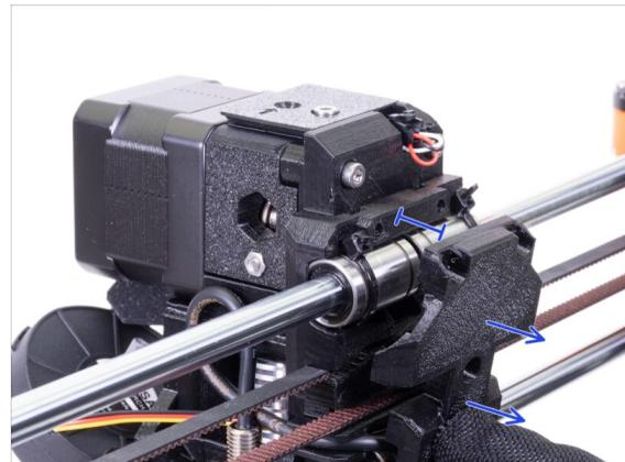
🟠 Lösen Sie alle vier Schrauben M3x10 auf der X-Schlittenrückseite, behalten Sie sie aber im gedruckten Teil.
