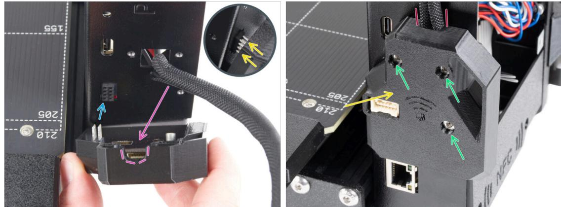
⚠ **Soyez très prudent lors de la manipulation et de la connexion du module ESP pour éviter de plier et d'endommager les broches.**
