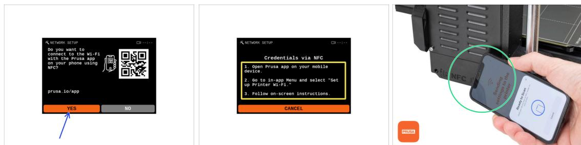
**💡** Der Bildschirm Netzwerkeinrichtung führt Sie durch die Verbindung mit einem Wi-Fi-Netzwerk. Wenn Sie Ihren Drucker jetzt noch nicht anschließen möchten, können Sie dies jederzeit später tun. In diesem Fall klicken Sie auf **Nein** und überspringen Sie diesen Schritt.
