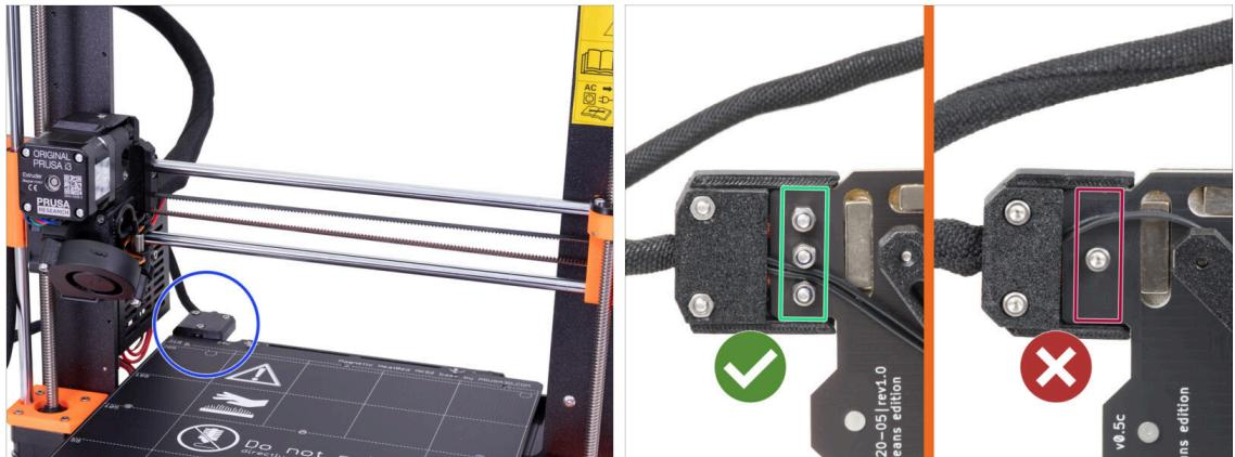
**⚠ Das Upgrade von MK3S/MK3S+ auf MK3.5S ist mit dem Heizbett kompatibel, das über verschraubte Stromkabel verfügt.**
