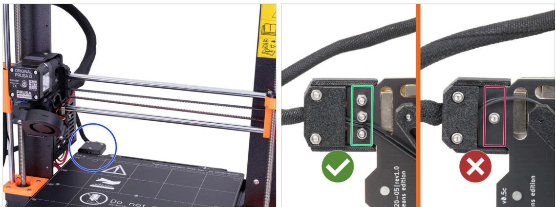
**⚠️ L'aggiornamento da MK3S/MK3S+ a MK3.5 è compatibile con i piani riscaldati dotati di cavi di alimentazione avvitati.**
