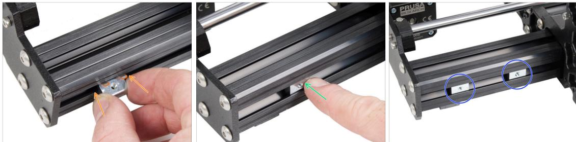
◆ Insérez l'écrou M3nEs dans le profilé court gauche (le côté sans le bloc d'alimentation). Insérez d'abord le côté avec le ressort (plaque métallique).
