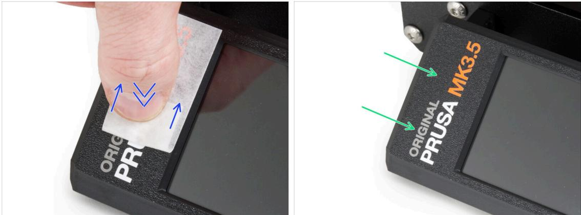
**⚠ Ce processus nécessite de la patience et du soin. Une adhérence parfaite dépend d'un bon dégraissage de la pièce et de la température ambiante.**
