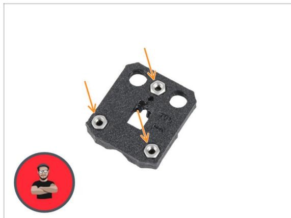
● Insérez trois écrous M3n dans les ouvertures profilées du heatbed-cable-cover-bottom.
