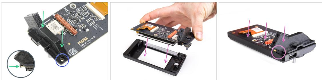
Umístěte úchyt xLCD-support-right na USB-connector-side (stranu s konektorem USB) na desce xLCD. Všimněte si malého háčku, který desku obepíná.
