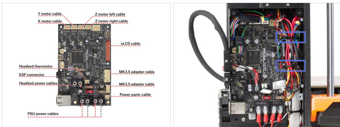
● Zkontrolujte zapojení elektroniky podle obrázku.
