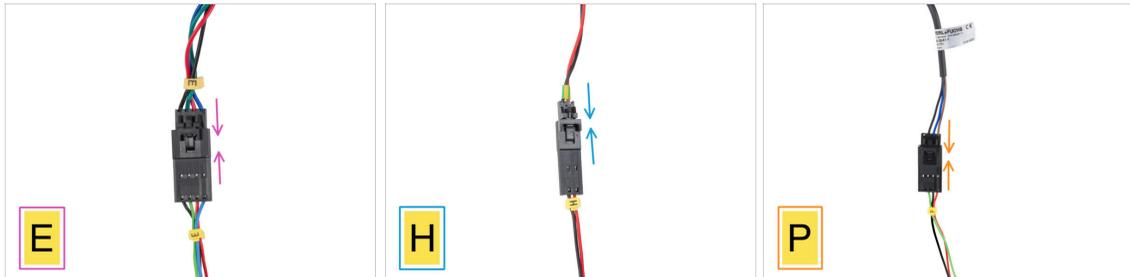
● Nyní zapojíme každý kabel extruderu do MK3.5 adaptéru. **Sledujte označení na adaptéru a označení a barvy kabelů vedoucích z extruderu.**
