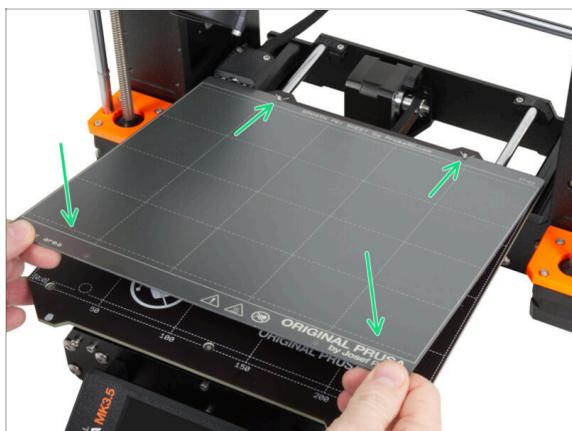
**!** Ujistěte se, že nic není na vyhřívané podložce. Podložka musí být čistá. Jakékoli nečistoty mohou poškodit povrch vyhřívané podložky i tiskového plátu.
