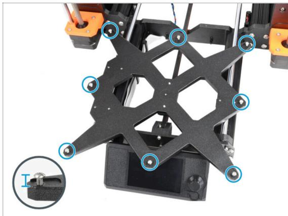
● Do vnějších otvorů na pojezdu Y-carriage našroubujte osm šroubků M3x6r. **Zatím je nedotahujte úplně.** Pár otoček bude prozatím stačit.
