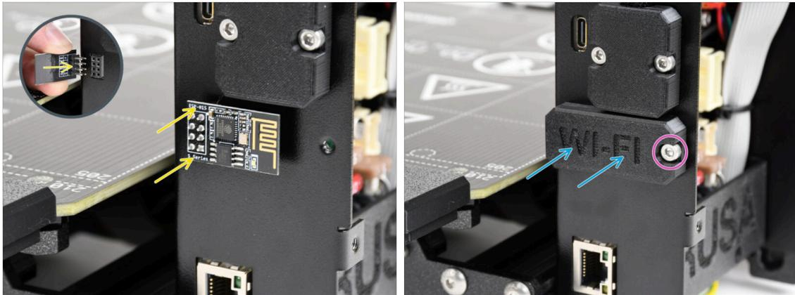
⚠ Při manipulaci a připojování ESP modulu **buďte velmi opatrní**, aby **nedošlo k ohnutí a poškození kolíků (pinů)**.
