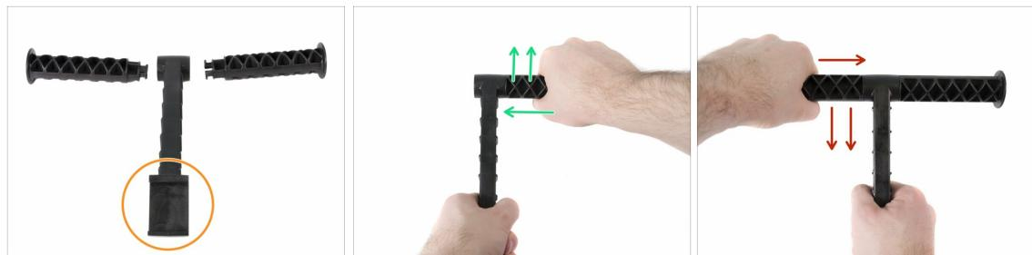
**⚠ Non esercitare troppa forza durante l'assemblaggio, o potresti danneggiare il sistema di blocco del supporto bobina.**
