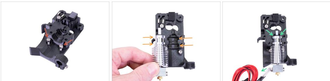
Prendi due viti M3x10 e inseriscile nei fori. In questo modo si facilita leggermente il montaggio, ma entrambi i fori sono poco profondi e le viti potrebbero cadere. In questo caso, è possibile continuare senza di esse e rimetterle a posto in un secondo momento (verrai avvisato in seguito). *Da notare anche che in alcune foto successive le viti potrebbero mancare.*
