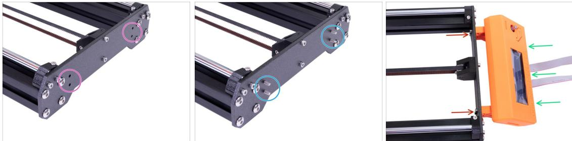
⚠ **ATTENZIONE!!!** Se non hai ancora installato i piedini antivibrazione, la parte anteriore della stampante poggerà sullo schermo LCD montato. Monta i piedini adesso, o fai molta attenzione poiché potresti danneggiare il supporto LCD. Per l'assemblaggio, torna a Capitolo 2 (Asse Y).
