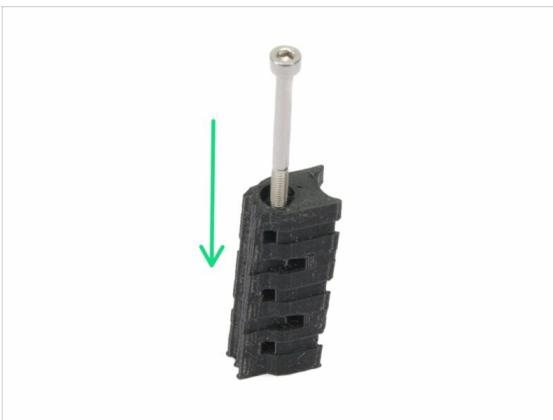
● Prepara una vite M3x40 e il reggicavo cable-holder del passo precedente.
