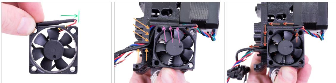
**⚠ Le ventilateur a deux côtés, l'un porte un autocollant. Assurez-vous que ce côté fait face à l'intérieur de l'extrudeur.**
