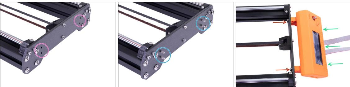
**⚠ ATTENTION !!!** au cas où vous n'auriez pas encore assemblé les pieds anti-vibrations, la partie avant de l'imprimante va reposer sur l'écran LCD. Montez les pieds maintenant ou faites très attention car vous pourriez endommager le support LCD. Pour l'assemblage retournez au Chapitre 2 (Y-axis).
