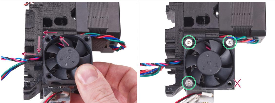
**⚠ VÉRIFICATION FINALE !** Le ventilateur est orienté avec le câble dirigé vers le haut, puis le câble passe par le canal supérieur jusqu'au X-carriage. Dans le X-carriage, n'oubliez pas d'utiliser les deux canaux. Assurez-vous que le **CÂBLE N'EST PAS PINCÉ** le long de son cheminement !
