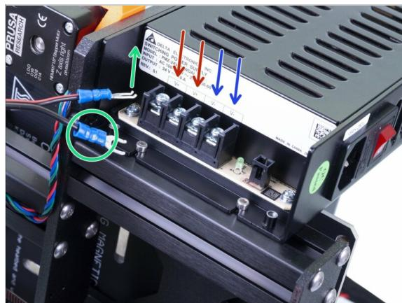
**⚠ ATTENTION : Vérifiez scrupuleusement la bonne connexion des câbles !!! Il y a un risque d'endommager l'alimentation ou l'imprimante elle-même si les câbles ne sont pas connectés correctement ou mal serrés !!!**
