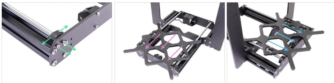
**⚠ IMPORTANT :** il est crucial d'aligner correctement les tiges lisses pour réduire le bruit et la friction en général.
