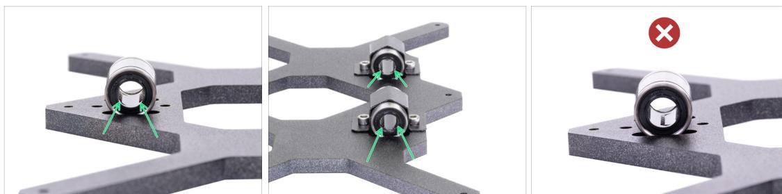
🟢 **L'orientation correcte** : Lorsque vous placez les roulements sur le Y-carriage, assurez-vous qu'ils sont orientés comme indiqué sur les deux photos. Une des pistes (rangées de billes) doit être sur le côté.
