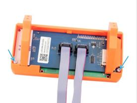
• Fija el controlador LCD en su sitio empleando la llave Allen 2.5mm y dos tornillos M3x10.
