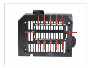
Einsy-base tiene una abertura de mantenimiento para la RPi Zero W o RPi Zero 2 W. Si tienes intención de utilizar este mini ordenador, puedes cortar con cuidado la pieza de plástico ahora. Más detalles aquí: help.prusa3d.com/article/prusaprin t-rpi-zero-and-octoprint 2180
