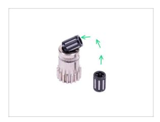
Introduce ambos rodamientos en la polea. Ten cuidado ya que los rodamientos pueden salirse durante el montaje.
