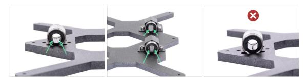
La orientación correcta: Cuando coloques los rodamientos en el carro Y, asegúrate de que están orientados como se muestra en las figuras. Las pistas (fila de bolas) deben estar en los laterales
